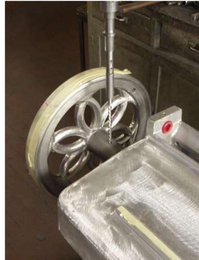
perçage conique du volant et de l'axe
